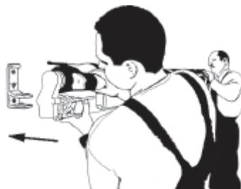
8) Sichern Sie das quadratische Markisenprofil mit Hilfe der Schraube M8x65 und montieren Sie anschließend die Kunststoffabdeckung.
