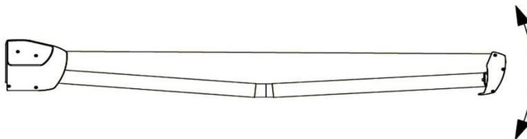
18) Mit Hilfe eines Inbusschlüssels lösen (Vergrößern des Neigungswinkels) oder Ziehen Sie (Verringern des Neigungswinkels) die Einstellschraube fester, um den Neigungswinkel zu ändern
