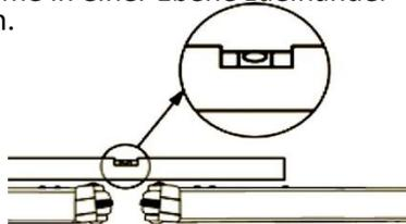
15) Montieren Sie das Verbindungsprofil mit den Haltern.
