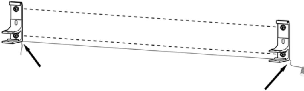
10) Hängen Sie die Markise in die Halter, so dass die Konstruktion maximal an den Halter gedrückt wird (Achtung – vor dem Einhängen ist zu prüfen, ob alle Halter sich im Lot befinden und auf einer ebenen Fläche montiert sind).
