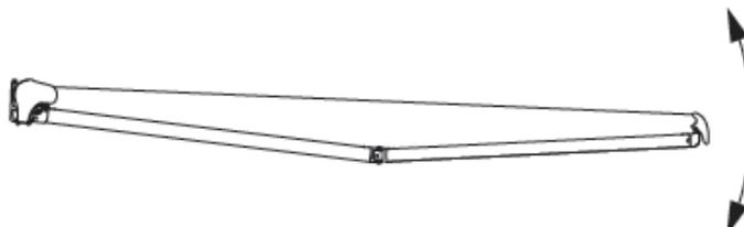
13) Mit Hilfe eines Inbusschlüssels lösen (Vergrößern des Neigungswinkels) oder ziehen Sie (Verringern des Neigungswinkels) die Einstellschraube fester, um den Neigungswinkel zu ändern.
