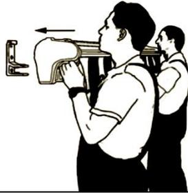
8) Sichern Sie das quadratische Markisenprofil mit Hilfe der Schraube M8x65 und montieren Sie anschließend die Kunststoffabdeckung.
