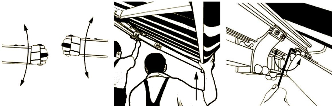
11) Prüfen Sie mit Hilfe der Wasserwaage, ob die Gelenkarme in einer Ebene zueinander schließen.
